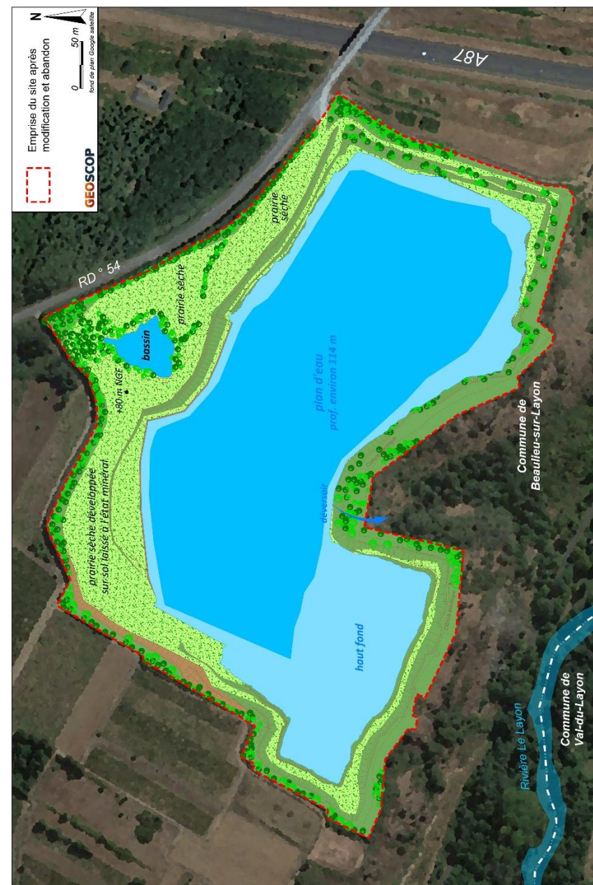
Esquisse du plan de remise en état à long terme après remontée des eaux
